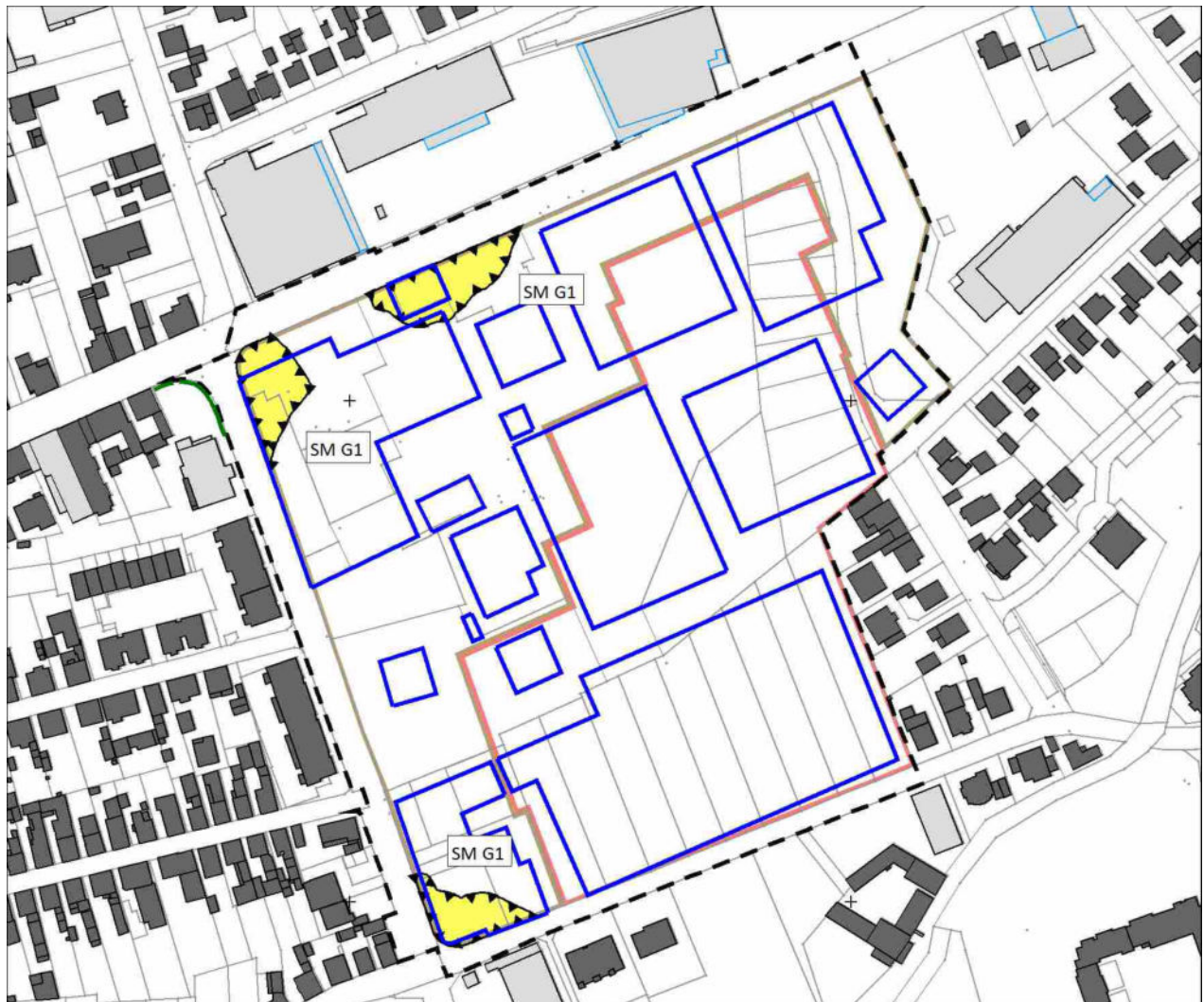
Abbildung 3 Schallschutzmaßnahmen SM G1
