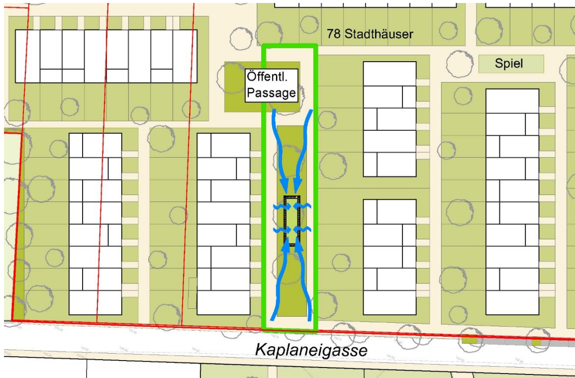
Abbildung 13 Beispielhafte Regenwasserbewirtschaftung einer öffentlichen Passage
